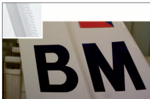
Obr. 5 Instalace turbulátoru – integrovaný se zatěsněním štěrbin, oddělené řešení = Zig-Zag páska + Mylar
