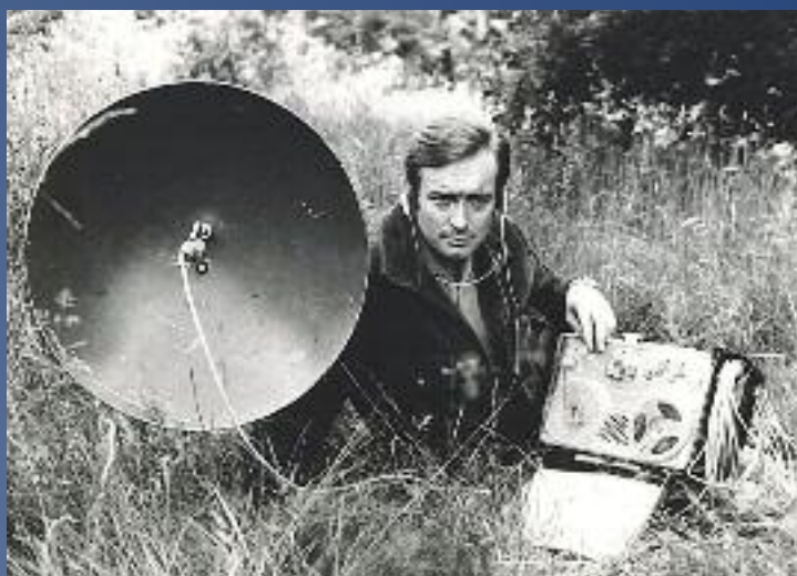
Oldřich Unger s magnetofonem Nagra III a parabolickým mikrofonom, s nímž strávil stovky hodin při nahrávání hlasů přírody v terénu. Fotografie z jarního natáčení zvuků u jihočeských rybníků v roce 1970 (pozn. red.: na tomto snímku údajně nahrává krtonožku).
