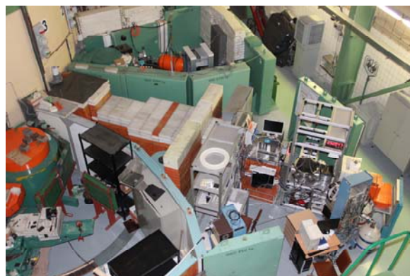
Obr. 2. Aparatury jaderných analytických metod na horizontálním kanálu č.3 reaktoru LVR-15.
