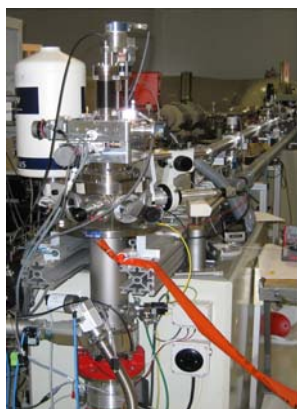
Obr. 3. Iontový mikrosvazek u urychlovače Tandetron.
