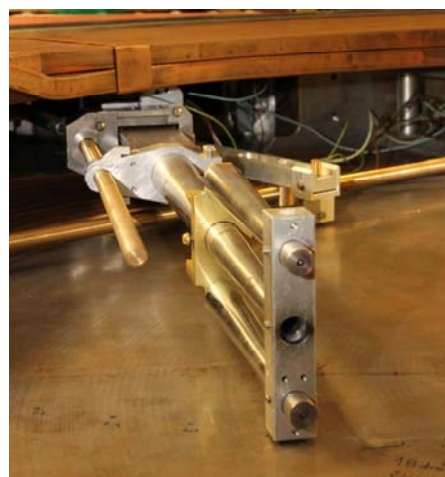
Obr. 5. Nový vývod elektronového svazku mikrotronu.
