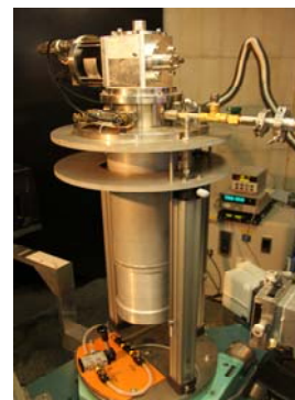
Obr. 4. Nový kryostat na neutronovém práškovém difraktometru MEREDIT.
