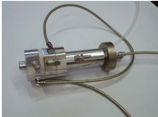
Obr. 1. Plynový terč pro přípravu radionuklidu {}^{83}\text{Rb} .
