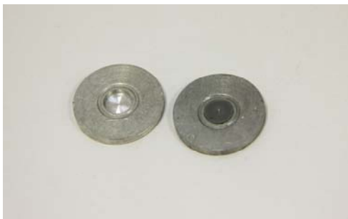
Terč z obohaceného molybden-100 pro přípravu technecia-99m v hliníkovém držáku a prázdný hliníkový držák po rozpuštění terče.
