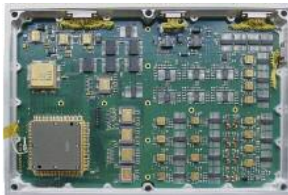
Prototyp modulu Time Domain Sampler (TDS) se stane součástí přístroje Radio and Plasma Wave Instrument, který měří elektromagnetické oscilace v meziplanetárním prostoru. Modul bude umístěn na kosmickou sondu Solar Orbiter k pozorování Slunce z malé vzdálenosti.
