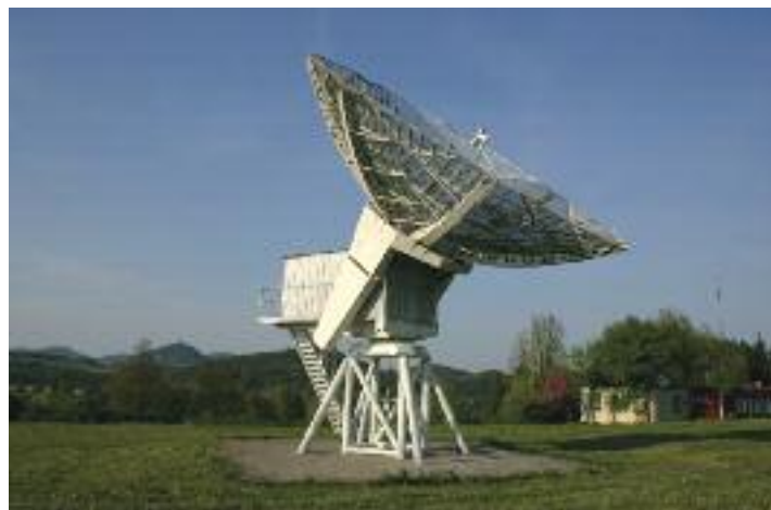
Družicová telemetrická stanice na observatoři Panská Ves je vybavena dvěma desetimetrovými parabolickými anténami, kterými se v současnosti přijímají data z družic projektu CLUSTER (ESA).
