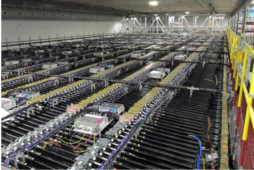
Pohled na horní část téměř dokončeného vzdáleného NOvA detektoru. Detektor je tvořen 28 PVC bloky o váze 190 tun a celý měří 15.5 x 15.5 x 60 m. Po sestavení a naplnění kapalným scintilátorem bude detektor vážit 14 000 tun. Fotografie poskytnuta se svolením NOvA kolaborace.
