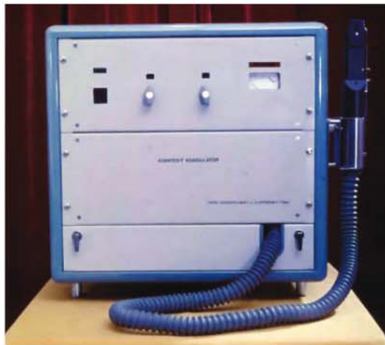
Obr. 9 Kvantový koagulator: sonda s miniaturním laserem a upraveným oftalmoskopem váží 65 dkg.
