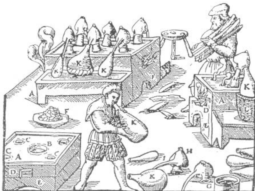
Obr. 9. Vlevo dole a vpravo pece k destilaci, nahoře pec k žhání a destilaci s baňkami v písečné lázni (Agricola 1933, obr. s. 378: „Pec A. Její okrouhlý otvor B. Průduchy C. Ústí peci D. Popelník pod ní E. Pánev F. Baňka G. Poklop H. Jeho nosák I. Jiná baňka K. Košík na uložení baňky, aby se nerozbita L.“).
