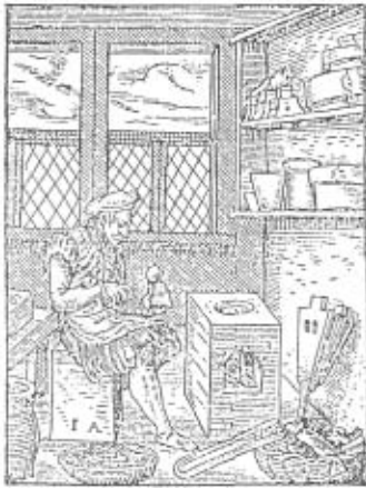
Obr. 15. Vlevo – písmolijec používá pícku k tavení litěiny (Kneidl 1989, 73; Hans Sachs, Eigentliche Beschreibung aller Stände auf Erden, Frankfurt a. M. 1574, dřevořez Josta Ammana), uprostřed a vpravo pícky s destilačním zařízením při výrobě kořalky (Renfrow 1997, obr. s. 209, 207).
