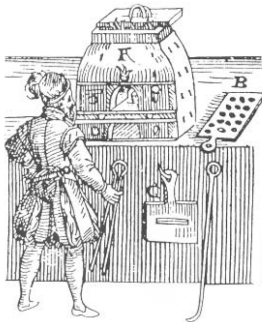
Obr. 6. Prubíř v dílně před prubířskou púckou (Ercker 1974, obr. s. 117, text s. 118: „Prubířská pec, v níž prubíř zkouší A. Železný plech, na nějž se vylévají průby B. Dřevěné zařízení, jehož šterbinou se díváme do pece, aby oheň neškodil zraku C.“).
