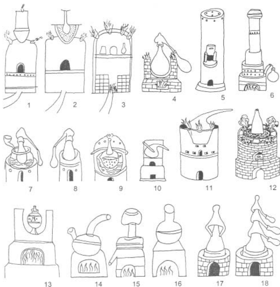
Obr. 17. Různé typy pecí používaných alchymisty a zvaných nejčastěji Athanon ; podle originálních předloh překreslil autor: 1–3 – destilační zařízení a pece (Priesner 1998, 265, obr. 12; De operationibus alchymiae , latinský rukopis, 14./15. stol., Bayerische Staatsbibliothek, Mnichov, Clm 405, fol. 171v); 4 – destilační pec s destilačním zařízením (Priesner 1998, 266, obr. 4; Das Buch der Heiligen Dreifaltigkeit , německý iluminovaný rukopis z r. 1400, Bayerische Staatsbibliothek, Mnichov, Cgm 598, fol. 77r); 5 – destilační či sublimační pec (Priesner 1998, 280, obr. 2; Libri 7 Gebri de summa perfectionis secretorum naturae , latinský rukopis z r. 1531, Bayerische Staatsbibliothek, Mnichov, Clm 2848, fol. 30v); 6, 13–16 – různá destilační a sublimační zařízení a pece s příslušenstvím, 15./16. stol. (Priesner 1998, 284, obr. 10–11; Bayerische Staatsbibliothek, Mnichov, Clm 25110 fol. 10r, 10v, 11r); 7–9 – různé alchymistické pícky používané při separaci a puterfakci (Klossowski de Rola 1991, 124–125; Anonym, 15. stol., British Museum, Londýn, Harley 2407, f. 106v–111); 10 – kresba alchymického aparátu ( Opus Magnum , obr. 39; rukopis Strahovského kláštera, sign. DG V. 19); 11 – pícka s destilačním zařízením (Read 1944, 241, obr. C); H. Bruinshwick, Buch zu Destillieren , Strassburg 1519); 12 – alchymistická pec ( Opus Magnum , obr. 42; Geber, De Alchimia , oddíl De Fornacibus construendis , liber I. Norimberk 1541); 17–18 – pícky s destilačními a separačními zařízeními (Klossowski de Rola 1991, obr. 8; Norton's Ordinal, 15. stol., British Museum, Londýn, Add. 10.302, f. 37v.). Překreslil autor.
