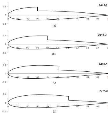
**Fig. 4. Airfoils developed for testing (a) 2415-3, (b) 2415-4, (c) 2415-5, (d) 2415-6.**
