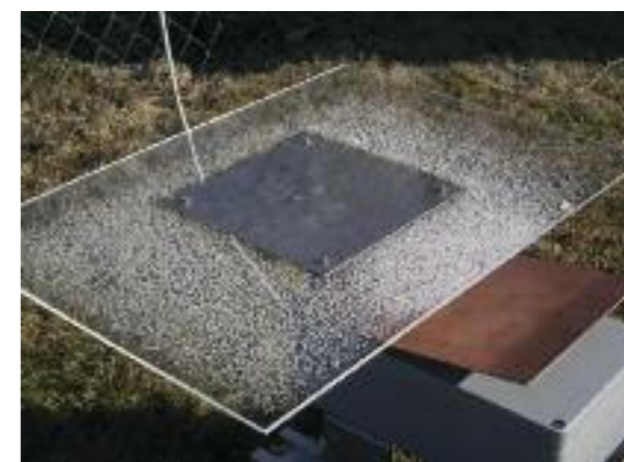
Přístroj na měření množství usazených srážek při testování na České zemědělské univerzitě v Praze-Suchbole
