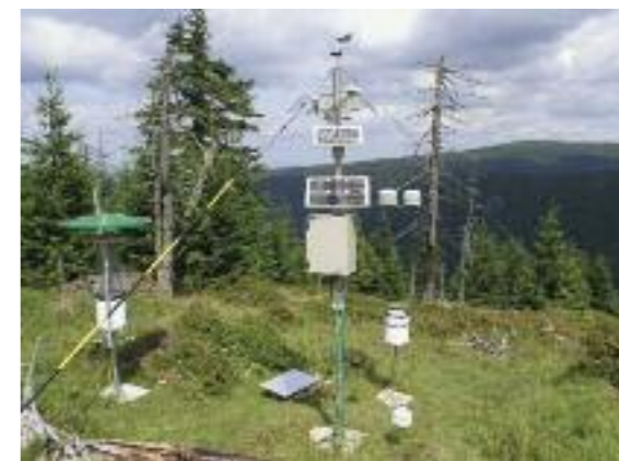
Stanice Smědava je vybavena meteorologickou stanicí, aktivním rosoměrem a pasivním zařízením na odběr vzorků vody z mlh.
