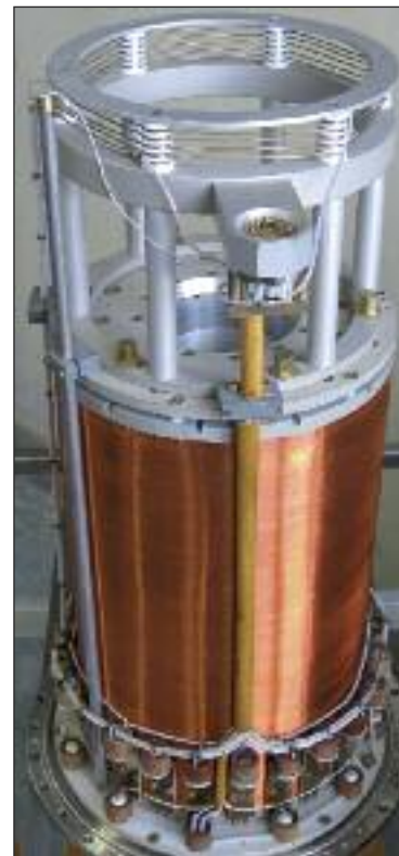
Supravodivý magnet 4,7 T pro NMR
