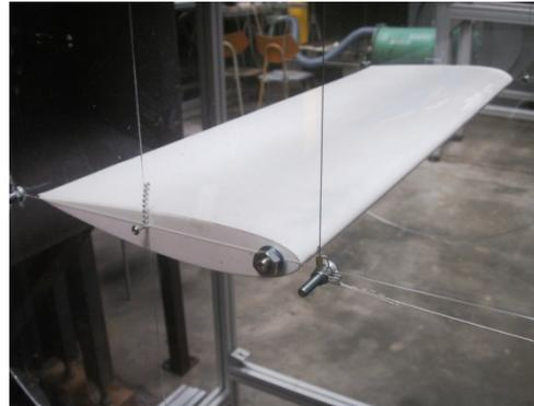
**Fig. 3. Endplate detail**
