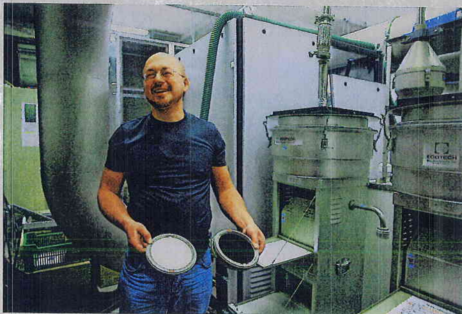
Tohle dýcháme. (M. Vojtíšek porovnává čistý filtr a filtr zanesený nanočásticemi z motoru)
