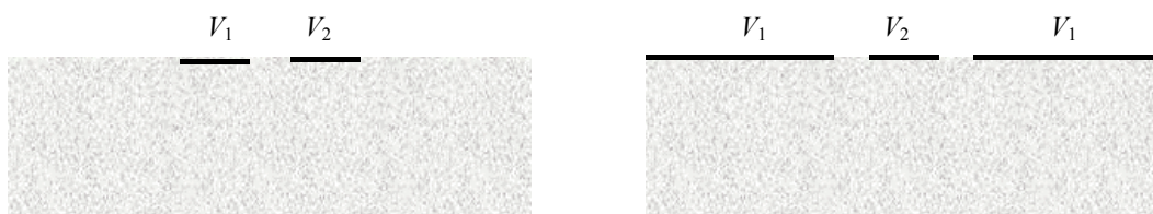
Obr. 9. Symetrické dvou vodičové a tří vodičové koplanární vedení.
