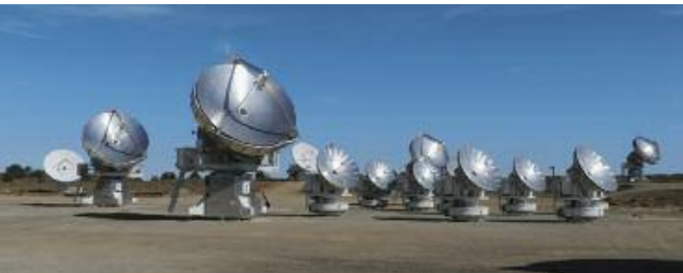
Kalifornská interferometrická soustava 23 spojených radioteleskopů CARMA (Combined Array for Research in Millimeter-Wave Astronomy).
