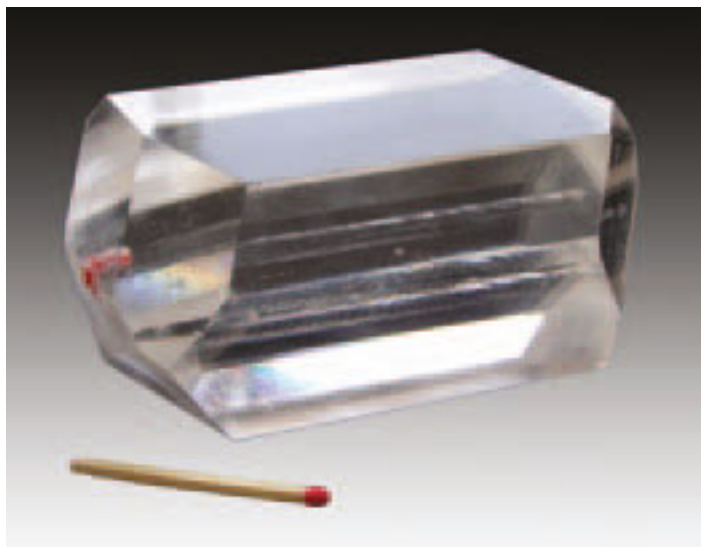
1/ Monokrystal síranu triglycinia (TGS) vypěstovaný z vodného roztoku metodou snižování teploty B. Březinou a M. Havránkovou v r. 1970. Krystal rostl po dobu pěti měsíců.
