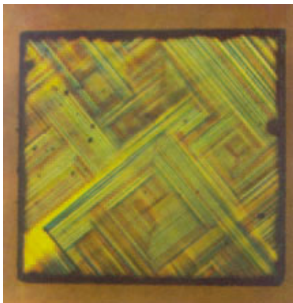
3/ Feroelektrické a zároveň feroelastické domény nevládního feroelektrika GMO pozorované v polarizačním mikroskopu na destičce (001). Obrázek představuje oblast cca 1,5 x 1,5 mm. (Podle B. Březiny, Čs. čas. fyz. A 27 , 363 (1977))
