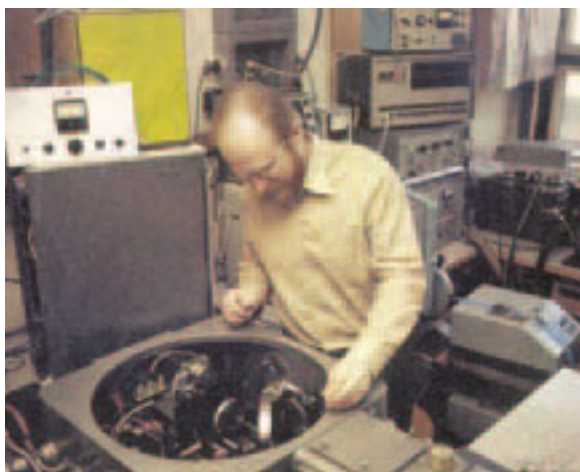
2/ J. Petzelt s historickým fourierovským spektrometrem RIIC FS620 z r. 1966 na dalekou IČ oblast, prvním v zemích tehdejšího socialistického tábora. (Převzato z časopisu Signál, 1982)
