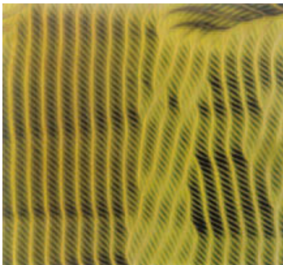
5/ Textura vzorku feroelektrického kapalného krystalu s modulací uspořádání molekul ve smektických vrstvách, zviditelněná v polarizačním mikroskopu. Šířka obrázku je 0,18 mm.
