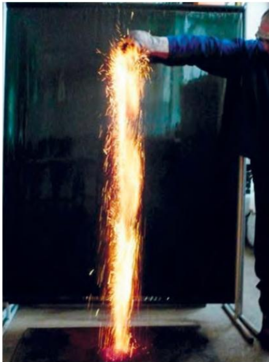
Obr. 2 Nanočástice \text{Fe}(0) v kontaktu se vzdušným kyslíkem demonstrují velkou reaktivitu nanočástic v produktu NANO FER 25 N, české firmy NANO IRON, s. r. o.
