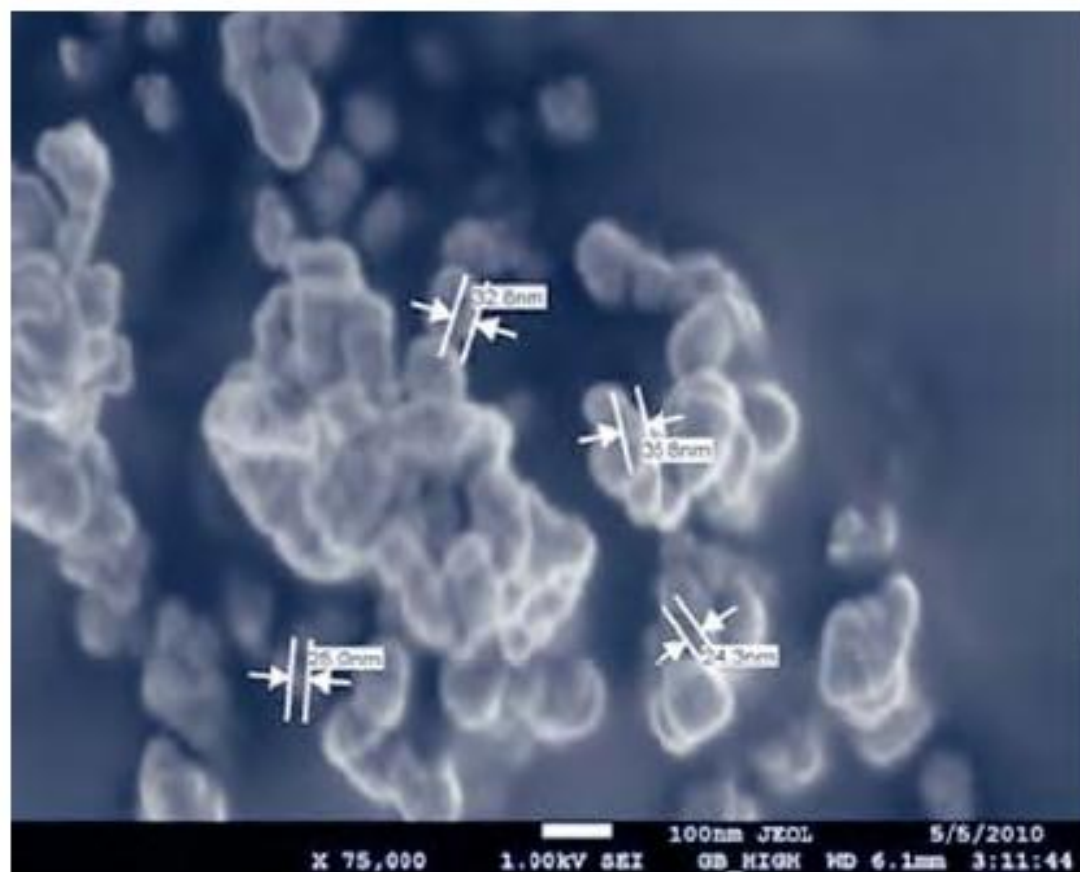
Obr. 5 Nanočástice ZnO připravené neúmyslně při rychlé depozici ZnO na podložce Si z plynné fáze technologií MOVPE. Nanočástice se kumulují podél vnitřní kondenzační křemenné roury a vznášejí se v plynné fázi i poměrně daleko za pecí.
