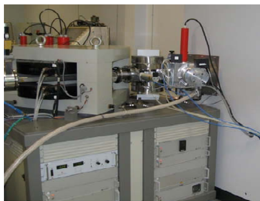
Obr. 3. Nový přídatný iontový zdroj urychlovače Tandetron.
