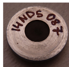
Ozářená terčová podložka se zalisovanou vrstvou nanodiamantů a radiogram ozářené vrstvy.
