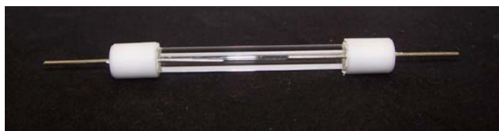
První návrh výbojové cely pro konverzi ^{18}\text{F} na elektrofilní formu.
