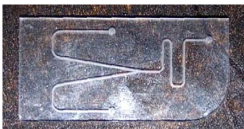
Frézovaný čip pro mikrofluidní systém z polymethyl methakrylátu (PMMA).
