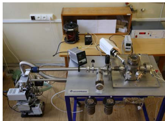
Obr. 2. UHV komora instalována na OJS.
