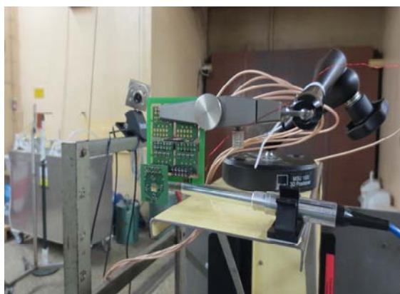
Obr. 1. Diamantový detektor na svazku protonů cyklotronu U-120M.
