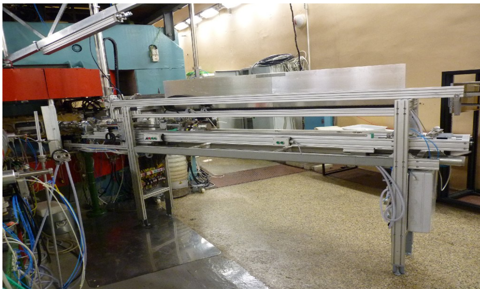
Obr. 2. Nová integrální sonda cyklotronu U-120M.
