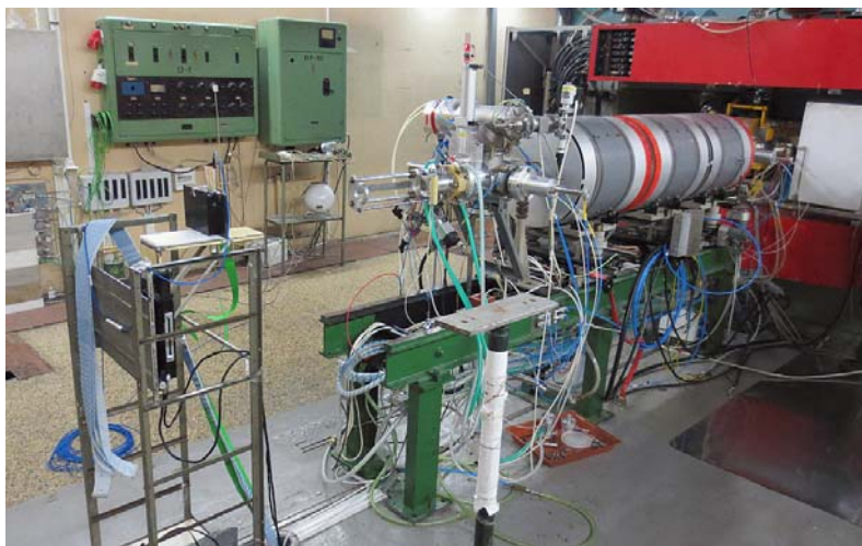
Měření pravděpodobnosti nežádoucích změn (tzv. Single Event Upset) stavu SRAM paměti ve svazku protonů na cyklotronu U-120M ÚJF v režii pro čipy plánovaného vnitřního dráhového detektoru experimentu ALICE.
