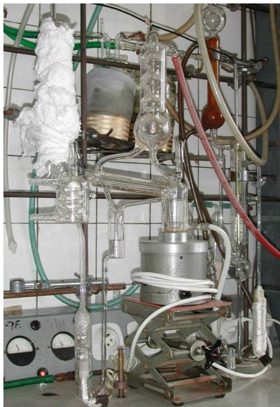
Celoskleněný cirkulační přístroj pro měření RKP
