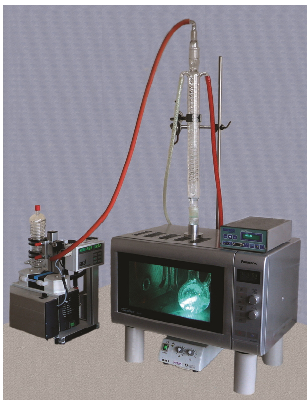
Experimentální uspořádání pro mikrovlnnou fotochemii a fotokatalýzu
