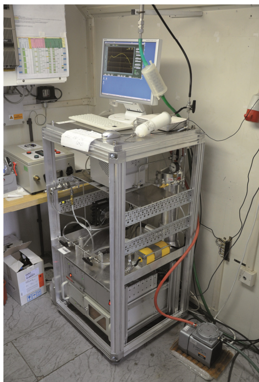
Skenovací elektrostatický třidič částic měřící velikostní rozdělení částic na pozadové lokalitě ČHMÚ Košetice
