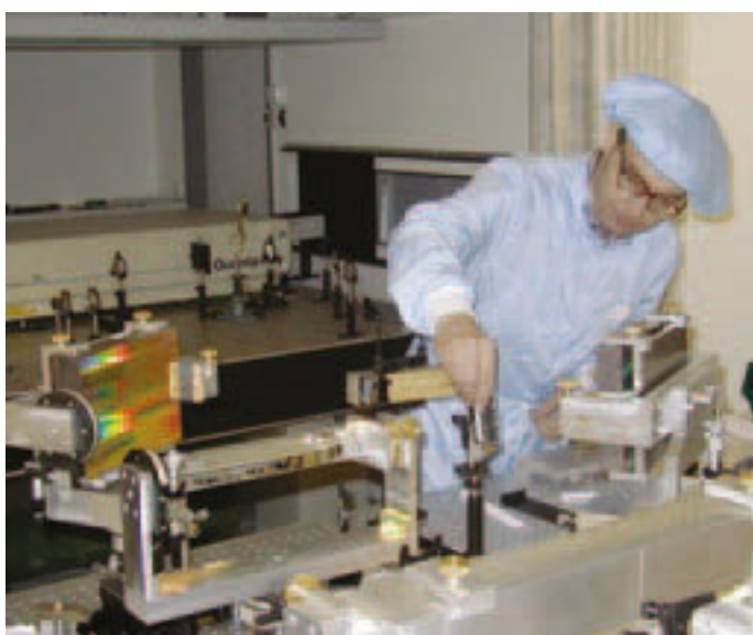
12/ Petr Straka u zárodků optického kompresoru pro OPCPA v laboratoři SOFIA - květen 2003 (foto J. U.)
