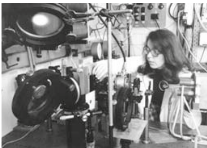
1/ Božena Králiková nastavuje zrcadla optické trasy laseru Perun (archiv B. Králikové)
