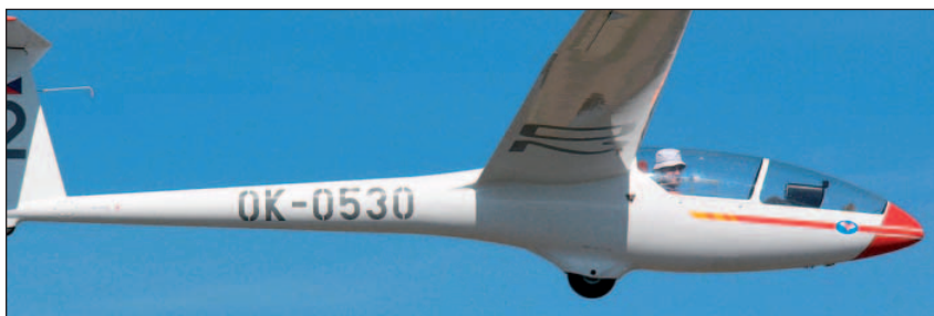
Obr. 6 Řešení štítku kabiny, tvar trupu a úhel nastavení křídla vůči němu
