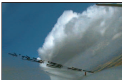
Obr. 7 Přechod křídlo-trupu, rastr bavlněných vláken – linie jejich přilepení je zvýrazněna šipkami. Zviditelnění proudění: nahoře přímknuté, V = 140 \text{ km/h IAS} , dole odtržené při přetažení, V = 75 \text{ km/h IAS} , \varphi = 30^\circ
