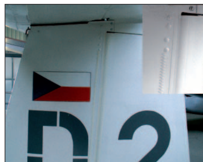
Obr. 8 Zig-zag pásky na VOP a SOP; Mylar fólie je použita jen na utěsnění směrového kormidla, v případě výškového by i při malé vychýlce vytvářela novou šterbinu
