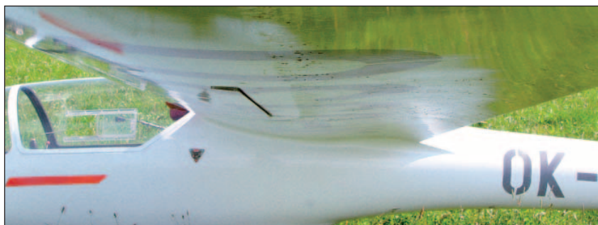
Obr.2 Povrchová vizualizace na spodním obrysu křídla VSO-10C, V = 95 km/h. Laminární a turbulentní mezní vrstva, zóna odtržení podél rozpětí. Obrazec zůstal zachován i po krátkodobém otevření brzdících klapek při přistání
