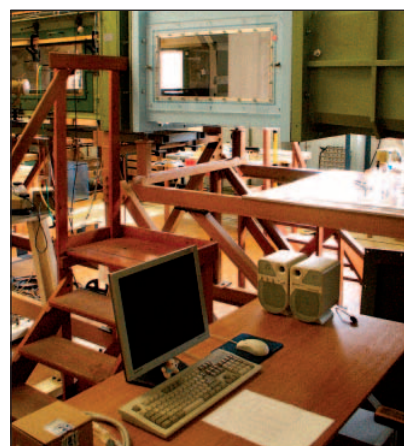
Obr. 10 Aerodynamický tunel 865x485 mm 2 UT AV ČR, měřicí prostor pro profily (2008)
