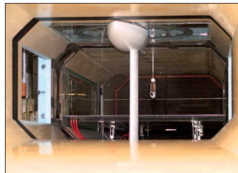
Obr. 7 Měřicí prostor 865x485x900 mm 3 cirkulačního aerodynamického tunelu UT AV ČR (2008)
