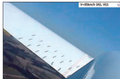
Obr. 10 Snímky z video záznamu letového zviditelnění proudění, TST10a, V = 85 km/h IAS, bez a s vírovým generátorem
