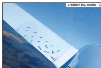
Obr. 9 Pole bavlnek na kořeni křídla TST10a, vlevo (zelený) vírový generátor VG1 h=3 mm
