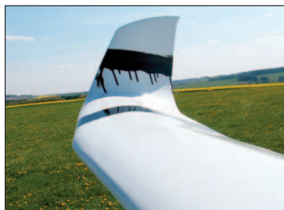
Obr. 2 Zviditelnění proudění olejem na wingletu TST10a
