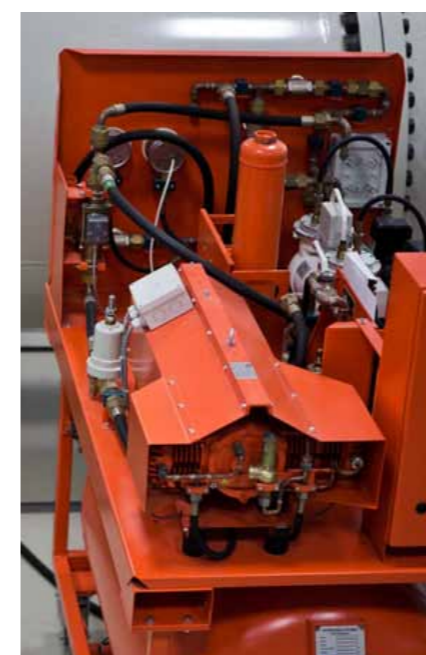
Přečerpávací a uskladňovací nádoba pro izolační plyn \text{SF}_6 , jímž je tlakována urychlovací část s vysokým napětím
