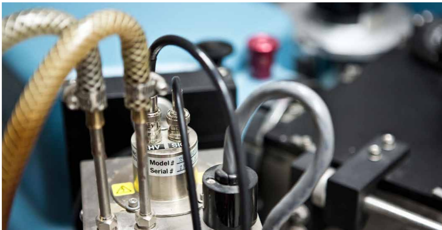
Detekční jednotka ve VUV spektrofotometru McPherson
