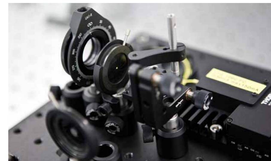
Speciální uspořádání optických hranolů navržené pro účinné buzení laserů založených na technologii tenkého disku
