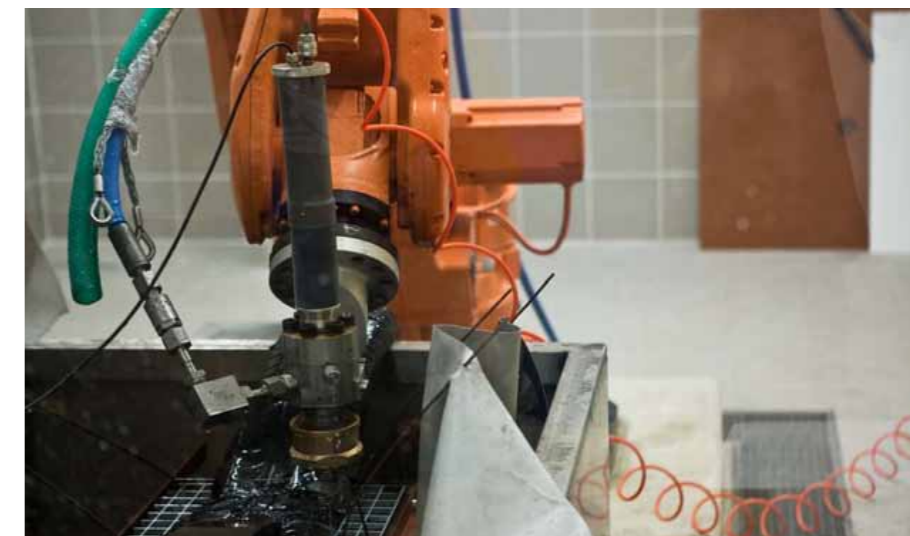
Robot ABB při manipulaci s generátorem pulzujícího vodního paprsku
