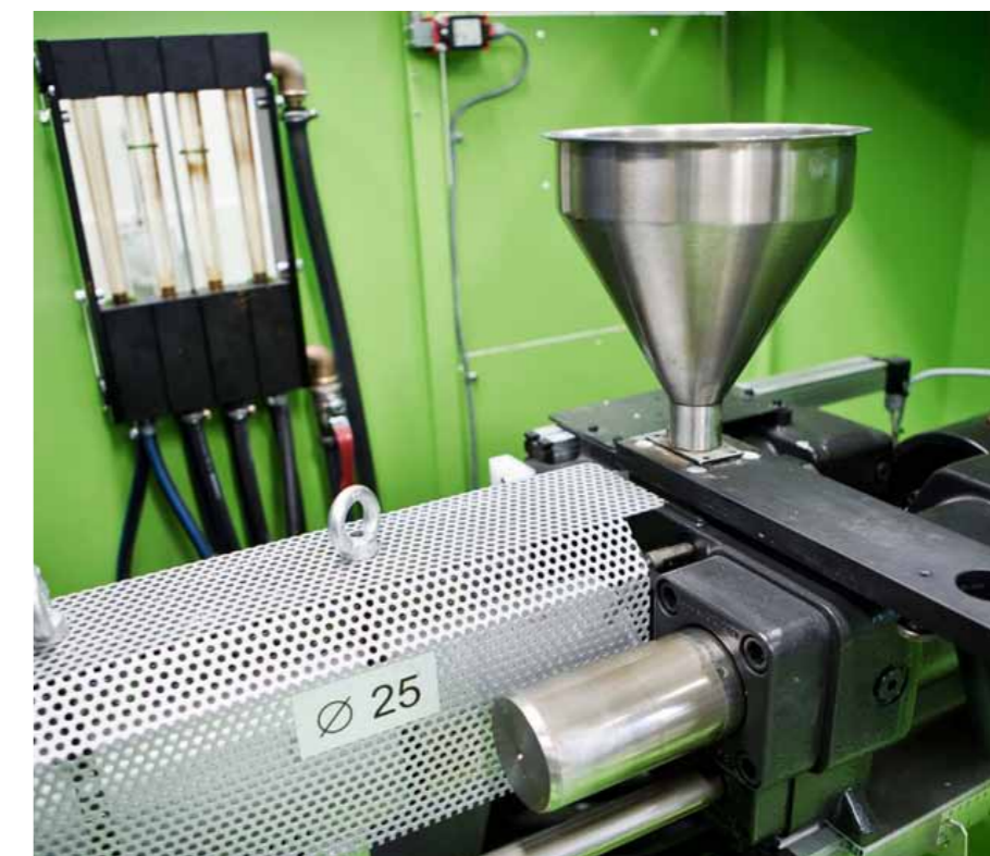
Centrum je vybaveno technologickým zařízením pro zpracování speciálních materiálů při vysokých teplotách (do 450 °C) a materiálů s vysokou abrazivitou
