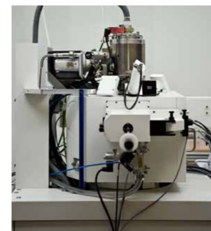
Kombinovaný elektronový litograf (EBL) a skenovací elektronový mikroskop (SEM)
