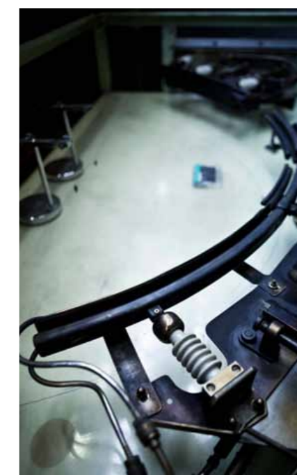
Deflekční systém pro vývod kladných iontů z cyklotronu
