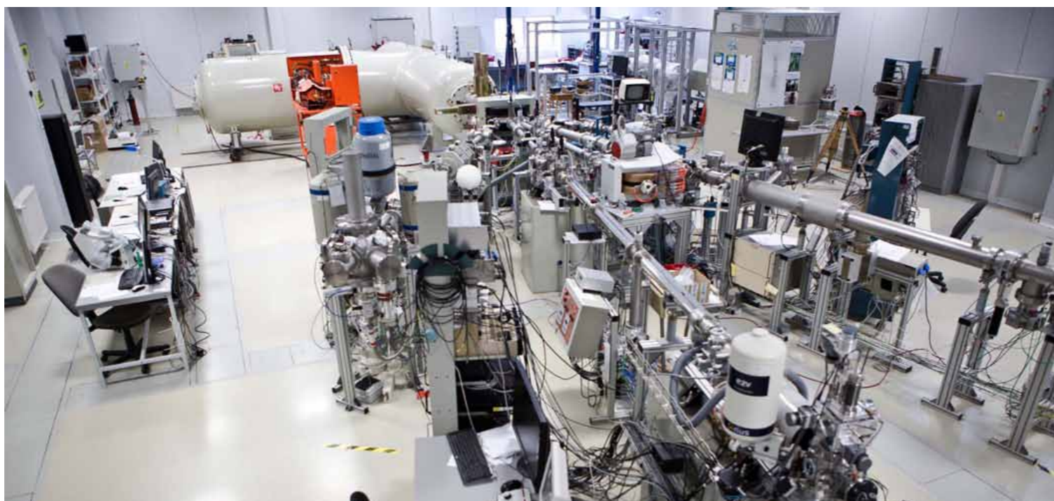
Laboratoř Tandetronu – pohled na iontové trasy s koncovými terčovými komorami pro iontové analytické metody
