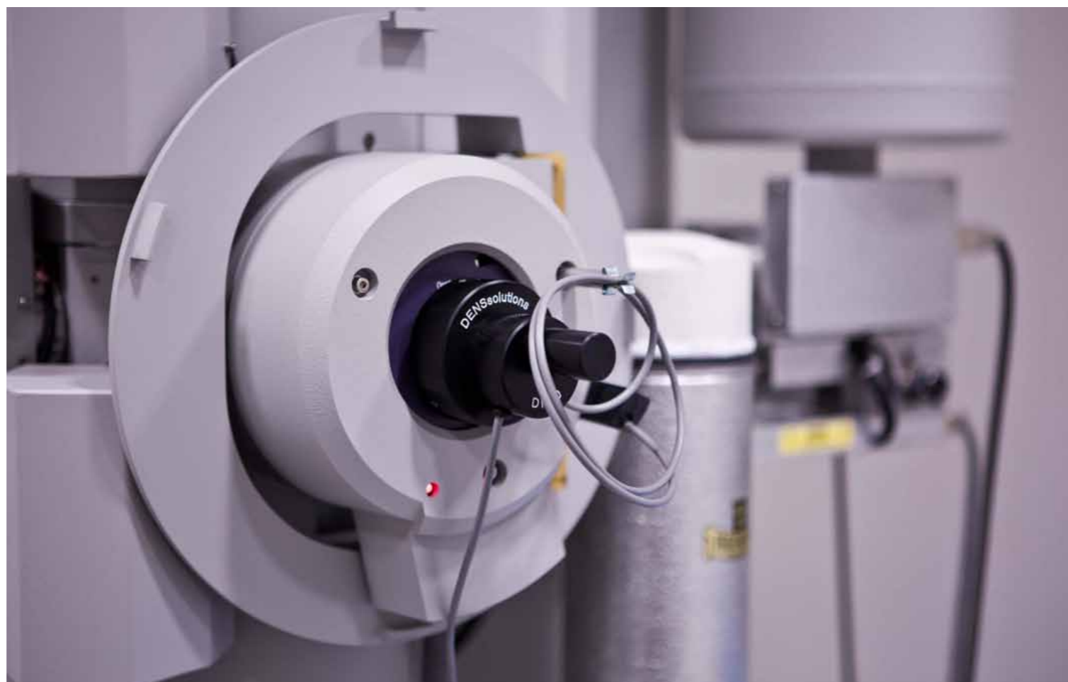
Detail vysokorozlišovacího transmisního elektronového mikroskopu (HR TEM)
