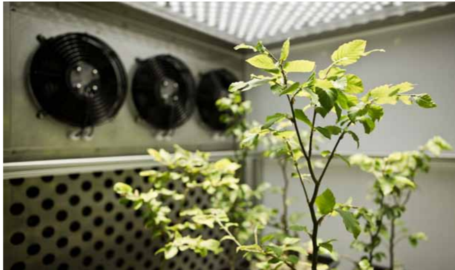
Růstové komory využívané k experimentům pro vyhodnocení dopadů globální změny umožňují kromě regulace základních parametrů, jako je teplota či vlhkost vzduchu, měnit také koncentraci oxidu uhličitého či spektrální složení světla
