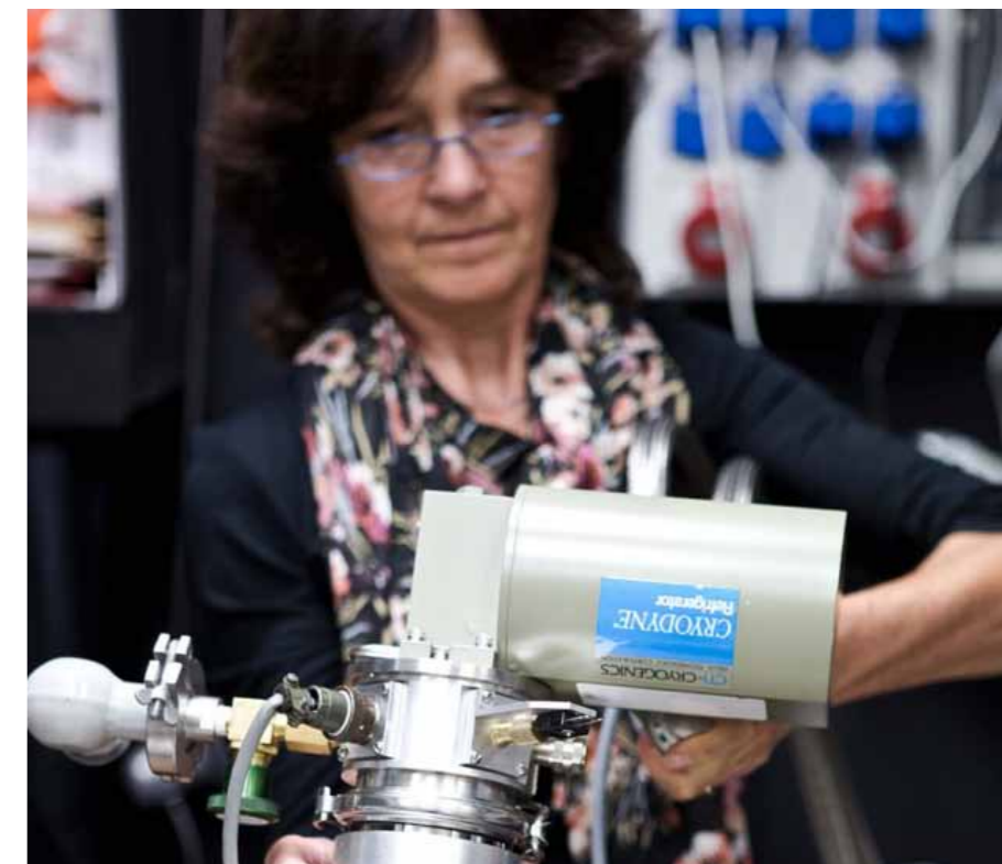
Kryostatová hlava refrigérátoru s uzavřeným chladicím okruhem Janis
