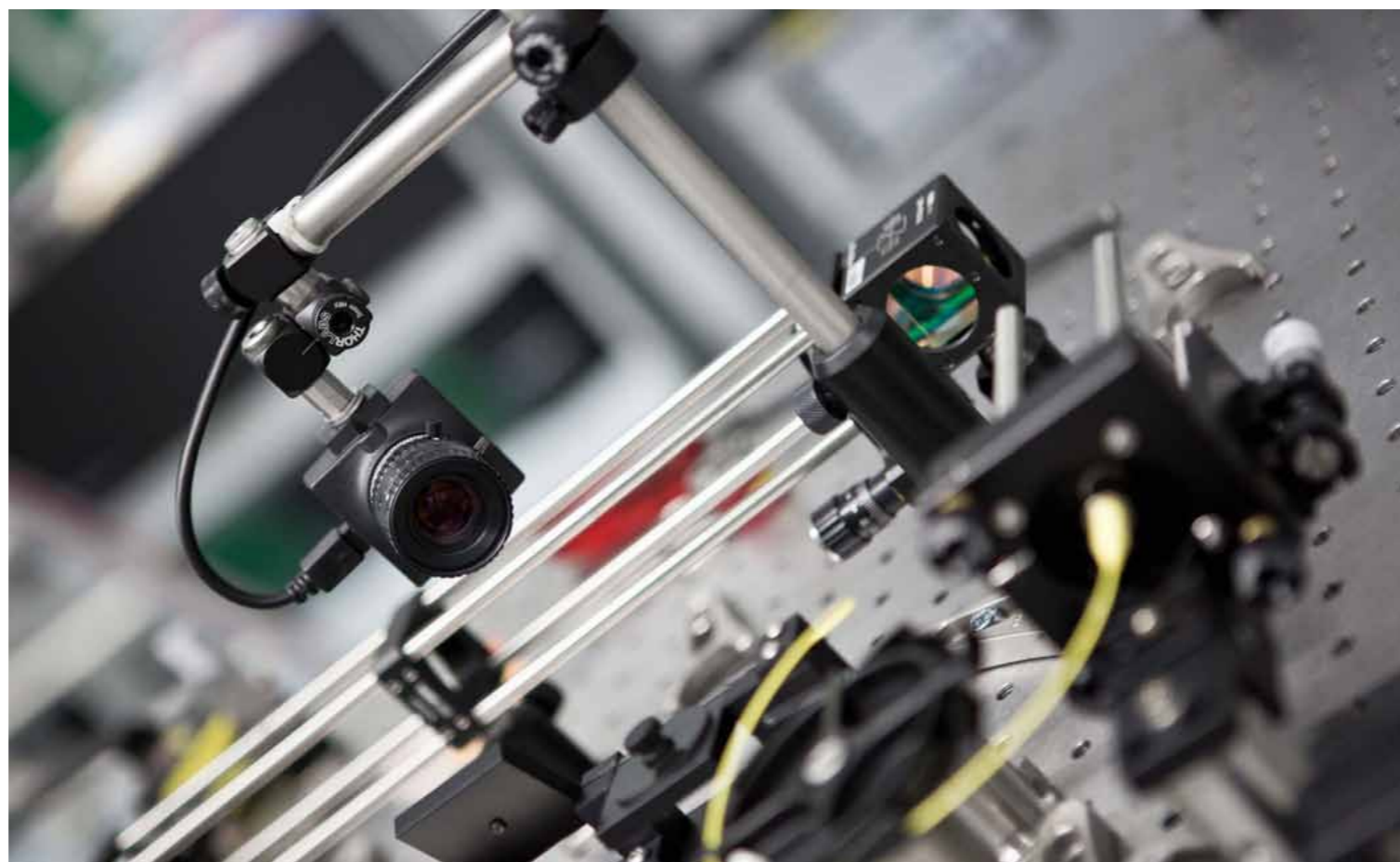
Experimentální sestava pro analýzu zakřivení povrchu tenkých laserových krystalů
