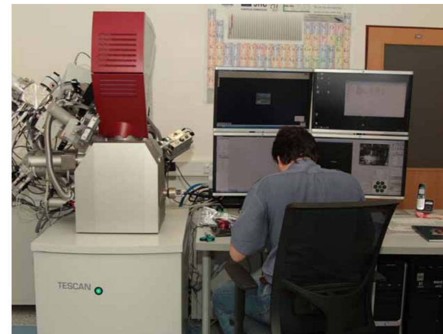
Skenovací elektronový mikroskop s fokusovaným iontovým svazkem TESCAN Fera3 k analýze povrchů a mikrostruktur funkčních materiálů
