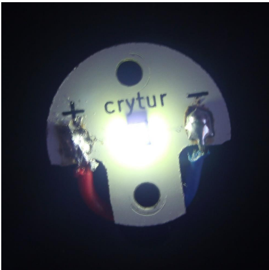
Obr. 2 Bílé světlo generované tandemem tvořeným budící modrou LED diodou (450 nm), jejíž světlo budí zeleno-žlutou emisi ve vloženém monokrystalickém elementu fosforu Y_3Al_5O_{12}:Ce . Složením těchto dvou spekter ve vhodném poměru je dopředu vyzařováno bílé světlo. Princip činnosti je znázorněn v horní části obrázku, funkční vzorek pak v dolní části.
