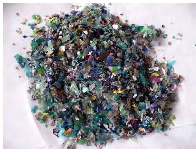
Obr. 1 – Vstupní surovina, směs odpadních PET vloček
