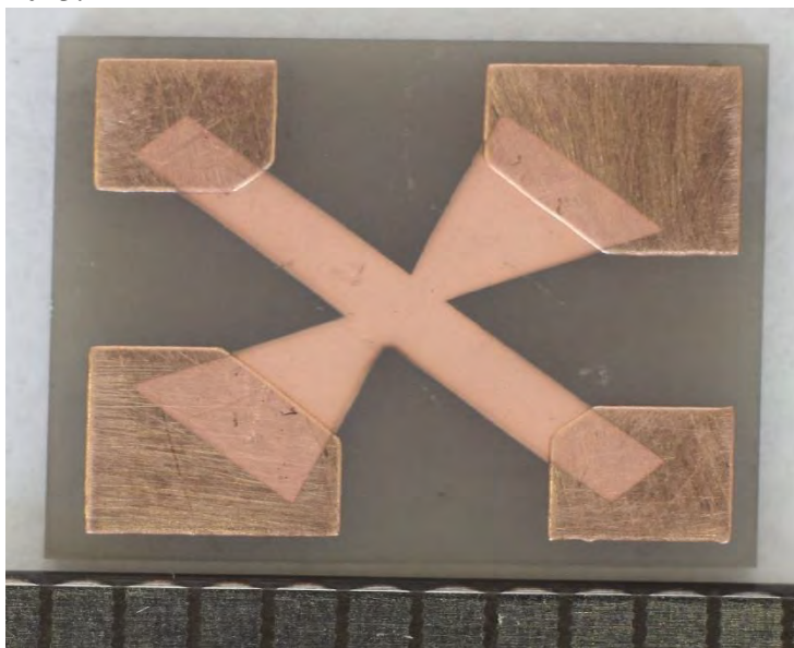
Kovový Halův senzor s měděnou citlivou vrstvou
