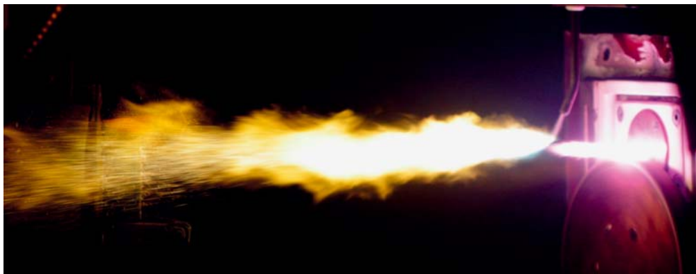
Nanášení wolframového povlaku plazmovým stříkáním. Jasně čáry vlevo jsou stopy jednotlivých zrníček wolframového prášku (velikost kolem 70 mikronů), roztavených proudem nízkoteplotního plazmatu (cca 10 000 K), tryskajícího z hořáku vpravo. Jasný „oblak“ uprostřed je kromě roztavených částic wolframu tvořen také vypařujícími se oxidy wolframu.
