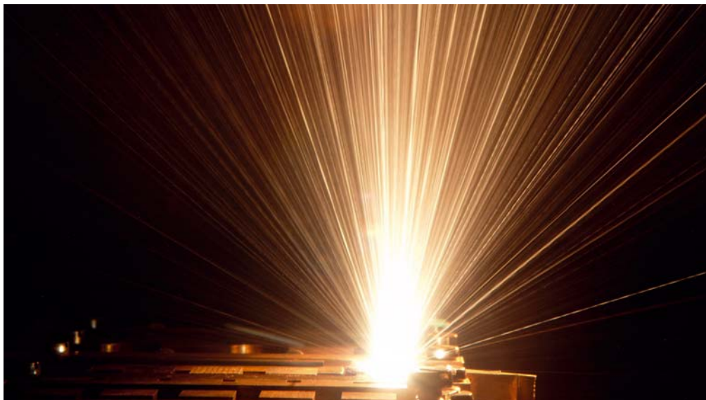
Ukázka zkoušky odolnosti proti tepelným šokům, kdy jsou podmínky disrupce simulovány intenzivním elektronovým svazkem. Jasně linie jsou stopy rozžhavených mikroskopických částic vyletujících z povrchu zasaženého materiálu.
