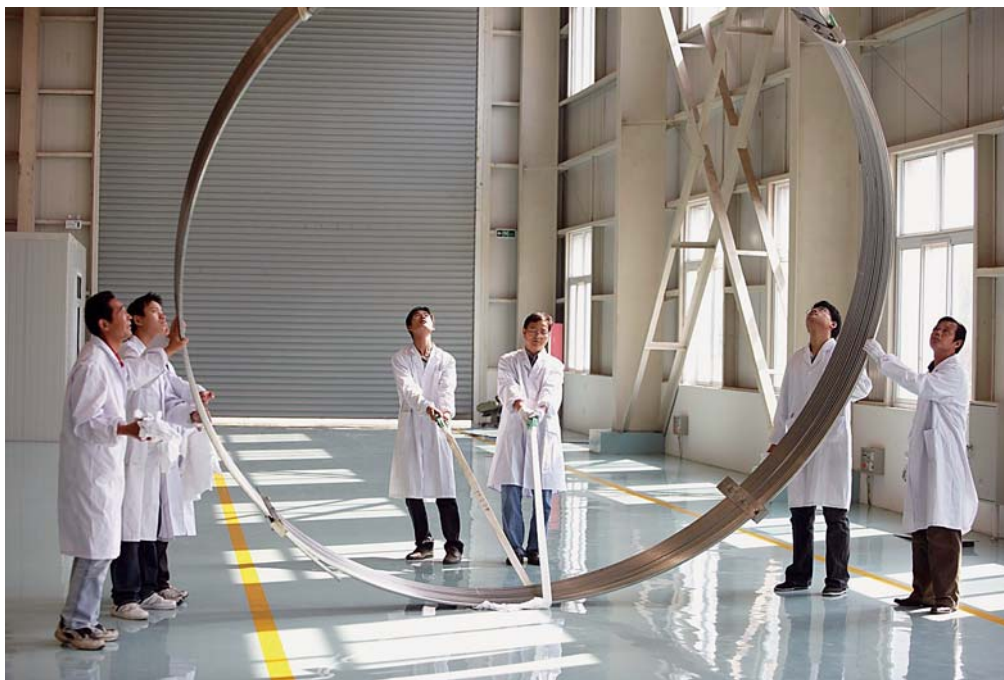
Model supravodivých korekčních cívek v Ústavu fyziky plazmatu Čínské akademie věd v Hefei.
