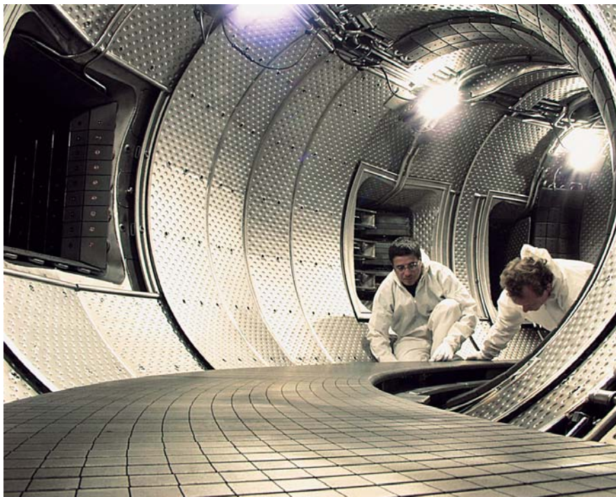
Toroidální limiter umožnil francouzskému supravodivému tokamaku Tore Supra odvod rekordního 1 GJ tepla v jediném výboji trvajícím 6:30 minut.
