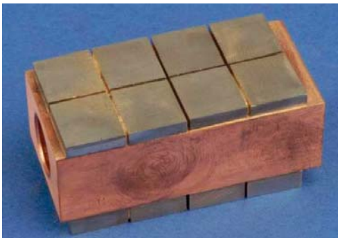
Ukázky zkušebních modulů (mock-ups) pro zkoušky tepelnými toky s aktivním chlazením. a) Dlaždice z kompaktního wolframu připájené na chladicí blok z Cu slitiny, b) plazmový nástřík wolframu nanesený přímo na chladicí blok s vyfrézovaným reliéfem pro lepší přilnavost.
