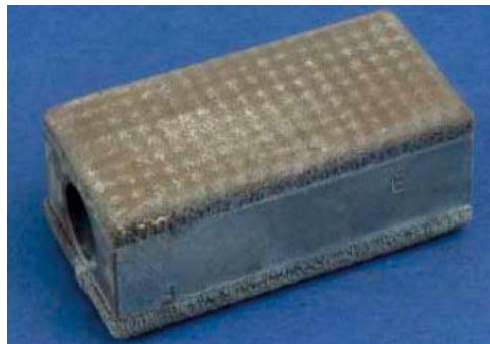
Ukázky zkušebních modulů (mock-ups) pro zkoušky tepelnými toky s aktivním chlazením. a) Dlaždice z kompaktního wolframu připájené na chladicí blok z Cu slitiny, b) plazmový nástřík wolframu nanesený přímo na chladicí blok s vyfrézovaným reliéfem pro lepší přilnavost.
