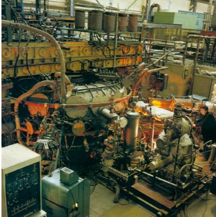
Na prvním supravodivém tokamaku na světě – moskevském T-7 – generovala v roce 1982 vlnovodná aparatura vyrobená v Ústavu fyziky plazmatu ČSAV proud 200 kA. Tehdy to byl světový rekord.
