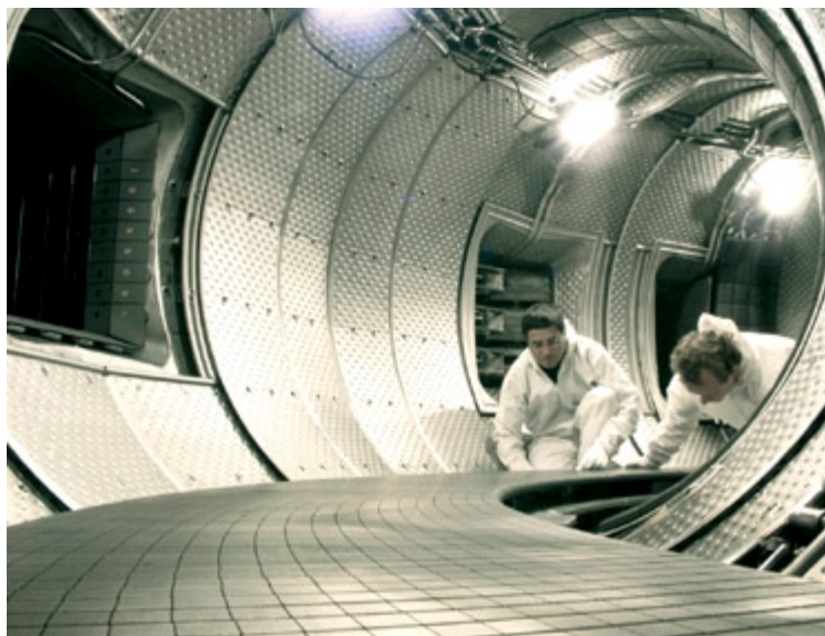
Toroidální limiter umožnil francouzskému supravodivému tokamaku Tore Supra odvod rekordních 1 GJ tepla v jednom výboji.
