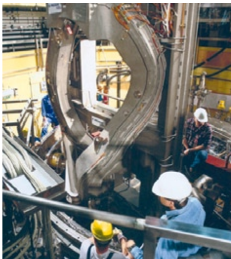
Test třídimenzionálního prototypu supravodivé cívky pro stelarátor W7-X ve Forschungszentrum Karlsruhe. Na obrázku je cívka před zapojením vsunována do kryostatu, který ji ochladí na -269\text{ }^{\circ}\text{C} .
