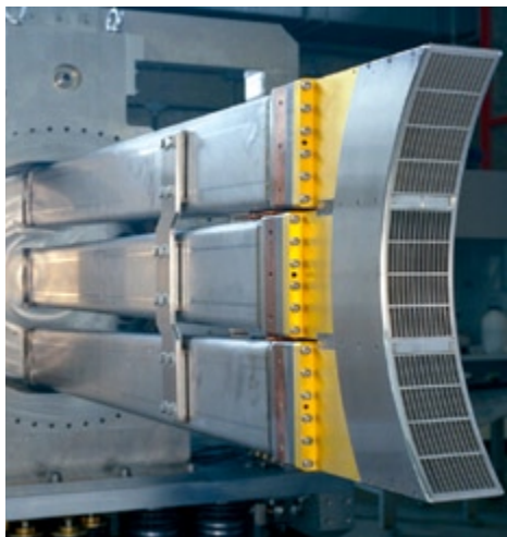
Vlnovod zavádějící vysokofrekvenční elektromagnetické pole pro dodatečný ohřev plazmatu do komory tokamaku v italském Frascati
