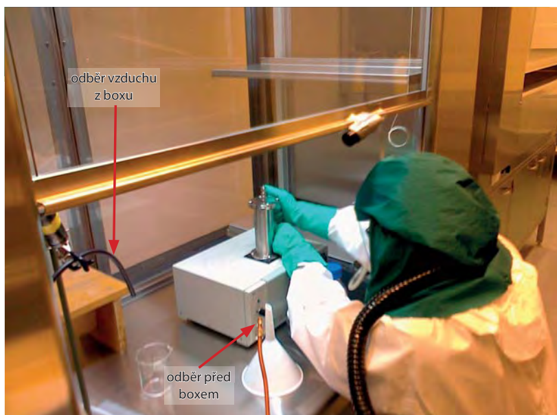
Obr. 7 Dokonalá ochrana pracovníka s vlastním přívodem vzduchu při práci s nebezpečnými objekty. (Z přednášky prof. Savolainenena v Praze, 2010, [51]).
