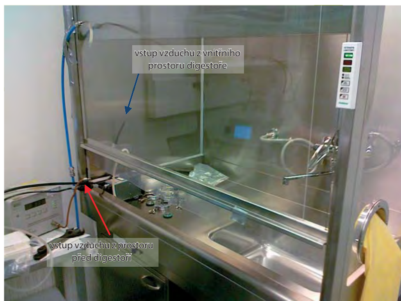
Obr. 6 Kontrola obsahu nanočástic v prostoru digestoře a před digestoří je prováděna dvěma hadičkami s možností kontinuálního odběru vzduchu. (Z přednášky prof. Savolainenena v Praze, 2010, [51]).
