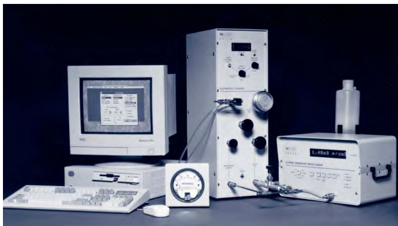
Obr. 8. Příklad zařízení (model 3934 SMPS), které umožňuje měřit počet částic a jejich rozměrové rozdělení v rozmezí 10–1 000 nm s použitím detekce elektrické pohyblivosti [53].
