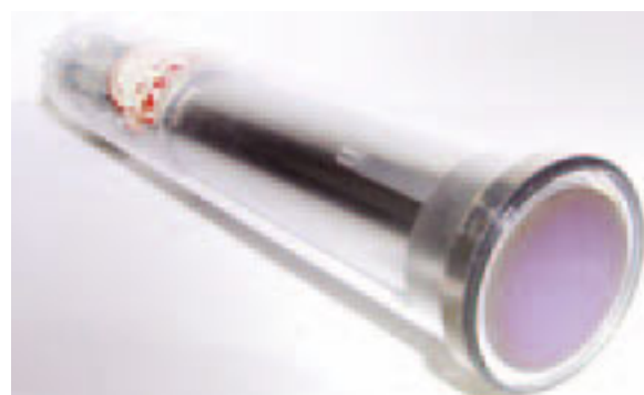
3/ Vidikon s terčíkem na bázi a-Si:H vyvinutý ve FZÚ a vyráběný ve spolupráci s Teslou Vakuová Technika.
