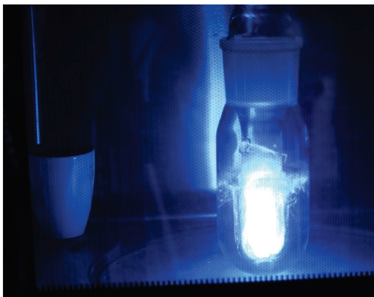
Experimentální uspořádání pro mikrovlnné fotochemické experimenty s bezelektrodoými výbojkami (EDLs)
