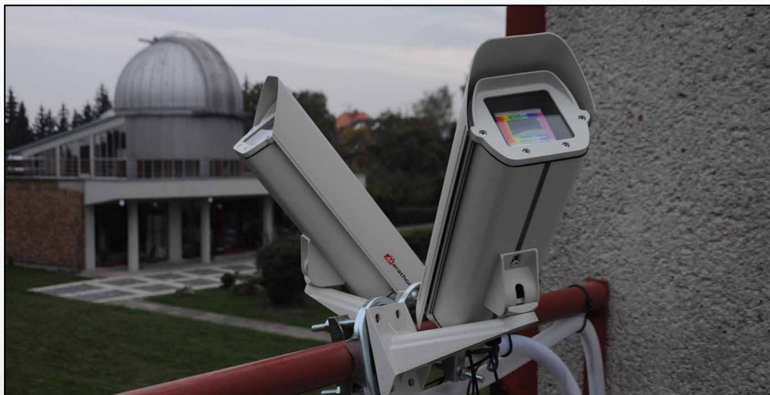
Kamera QHY5LII-M, zakoupená v roce 2015 v projektu Regionální spolupráce AV ČR reg. č. R200401521, dovoluje pořizovat spektra s rozlišením 0,97 nm/px
