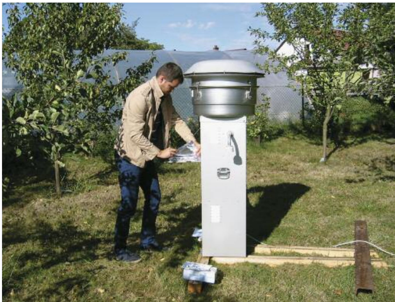
Měření ovzduší (PM2.5 a PAU) s občany Ostravy pomocí velkoobjemového čerpadla – High Volume Air Sampler.
