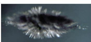
*Snímky z ultrarychlé kamery zachycující primární fázi výbuchu kapky slitiny sodíku a draslíku ve vodě. Pohled shora zachycuje kapku kovu při dotyku s vodní hladinou, ze které se uvolňují elektrony (modrá barva). Pohled zdola ukazuje, jak z kapky vylétávají kousky kovu při tzv. coulombovské explozi.*
