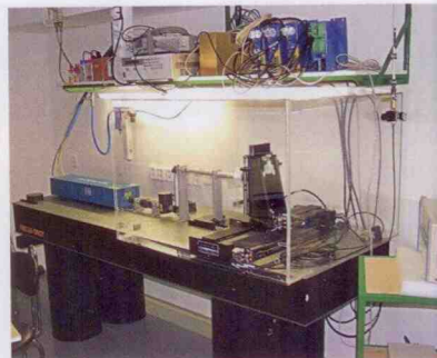
■ Technologické aparatury pro tažení optických vláken a pro zápis mřížek do vláken výkonným laserem
