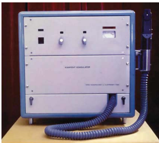
Obr. 9 Kvantový koagulátor: sonda s miniaturním laserem a upraveným oftalmoskopem váží 65 dkg.
