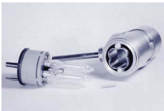
Obr. 6 Rubínový laser ÚRE-ČSAV v rozloženém stavu: mezi výbojkami se uchycuje rubínový krystal (v popředí), čtyřeliptická dutina se použila k dosažení vyšší účinnosti čerpacího záření (květen 1963).
