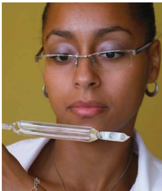
Obr. 8 Příklad preformy dvouplášťového optického vlákna s nekruhovým průřezem pro snadné navazání čerpacího a signálového vlákna připravené v ÚFE.
