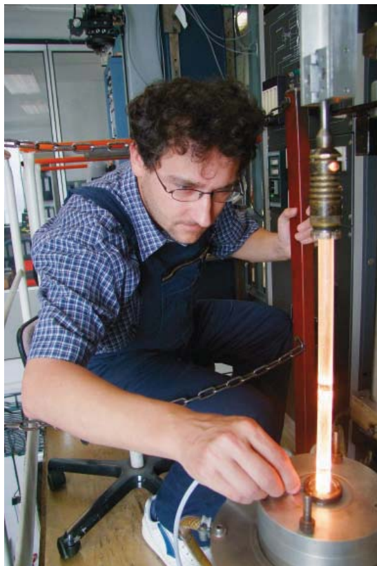
Obr. 7 Preforma optického vlákna zasunutá do grafitové pece v nejhořejší části jedné ze dvou tažících věží pro přípravu experimentálních optických vláken v ÚFE.
