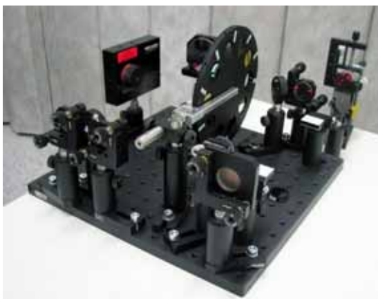
/// Obr. 10 Prototyp kompaktního uspořádání dvojdimenzionálního zobrazujícího spektrografu na podložce 30 cm x 30 cm (vlevo); přístrojem změřená úhlová disperze prodlužovače impulsů – tj. závislost úhlu směru šíření spektrální složky svazku na její vlnové délce (vpravo).
