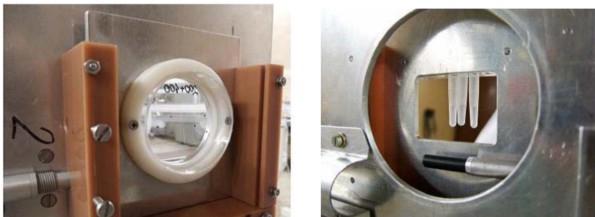
Obr. 2. Ozařování suchých vrstev plasmidové DNA (vlevo) a ve vodných roztocích vybraných vychytávačů volných radikálů (vpravo) na cyklotronu U-120M.
