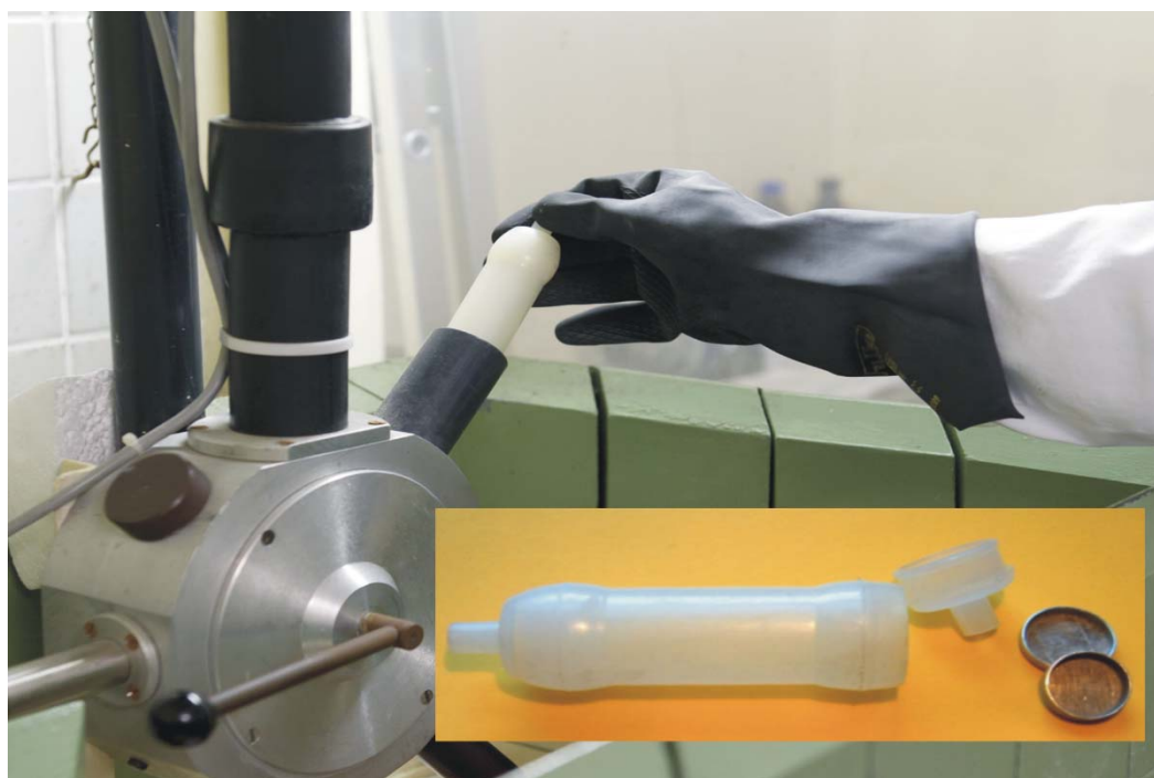
Pro transport vzorků do aktivní zóny reaktoru byla využita potrubní pošta. (Foto Jacob C. Ravn).
