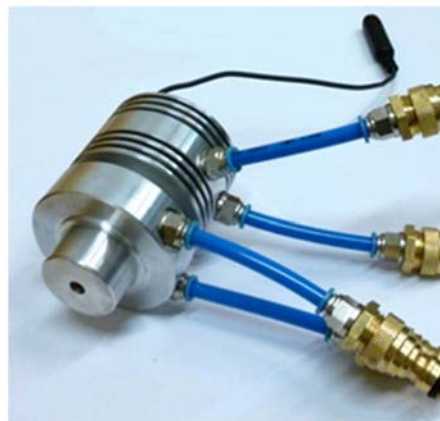
Vodou chlazený terçový systém pro produkci fluorescenčních diamantových nanočástic.
