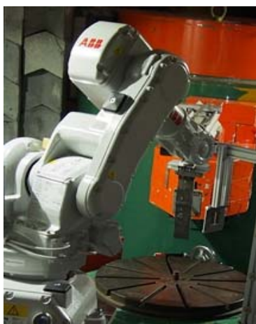
Obr. 3. Nový robot na difraktometru SPN-100 polohující svařované ocelové pláty v neutronovém svazku.
