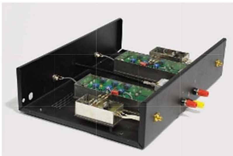
Obr. 3. Násobič časové odchylky využívající principu duálního směšování – klíčová část systému pro měření frekvenční stability oscilátorů
