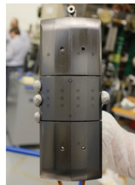
Testovací komponenta první stěny tokamaku COMPASS pro studium toku energie a částic z plazmatu
