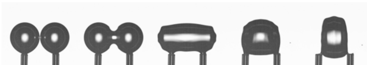
Bubliny na kapilárách synchronně rostou, až dojde k jejich doteku (konec fáze nafouknutí bublin a začátek fáze kontaktu) Poté dochází buď ke koalescenci obou bublin, nebo k oddělenému odtržení od kapilár
