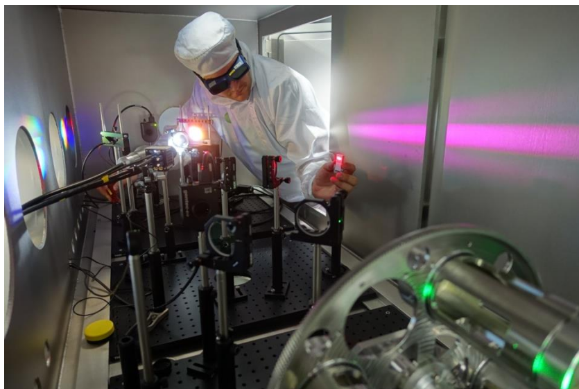
Obr. 9: Experimentální stanice pro testování prahu poškození (Fyzikální ústav AVČR, v.v.i.).
