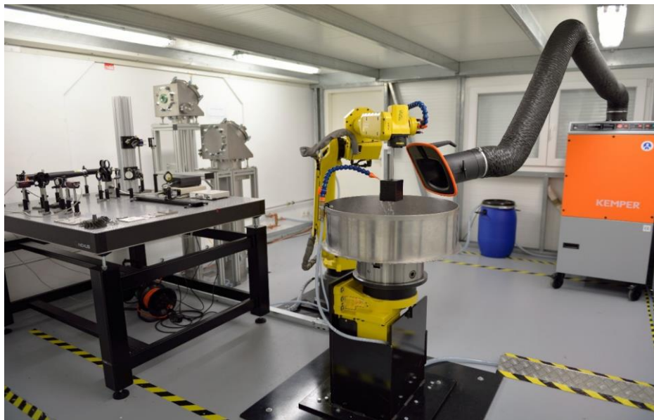
Obr. 8: Experimentální stanice pro studium laserového vyklepávání materiálů rázovou vlnou (Fyzikální ústav AVČR, v.v.i.).
