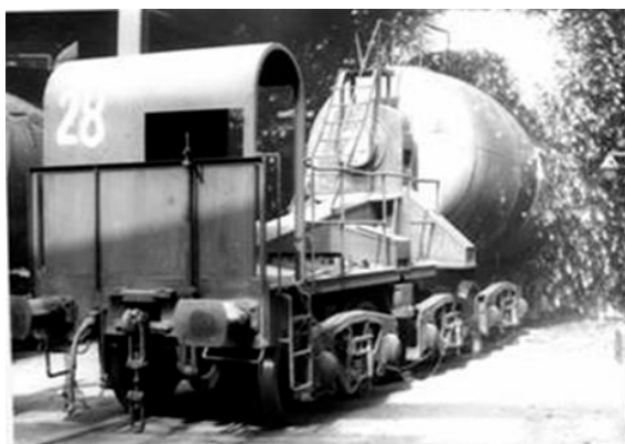
Obr. 5. Plnění převážecího vozu tekutým železem.
