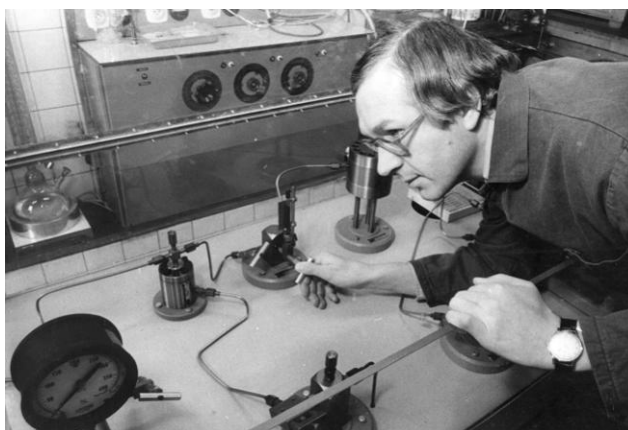
Obr. 7. Aspirant J. Drahoš obsluhuje tlakovou váhu RUSKA
