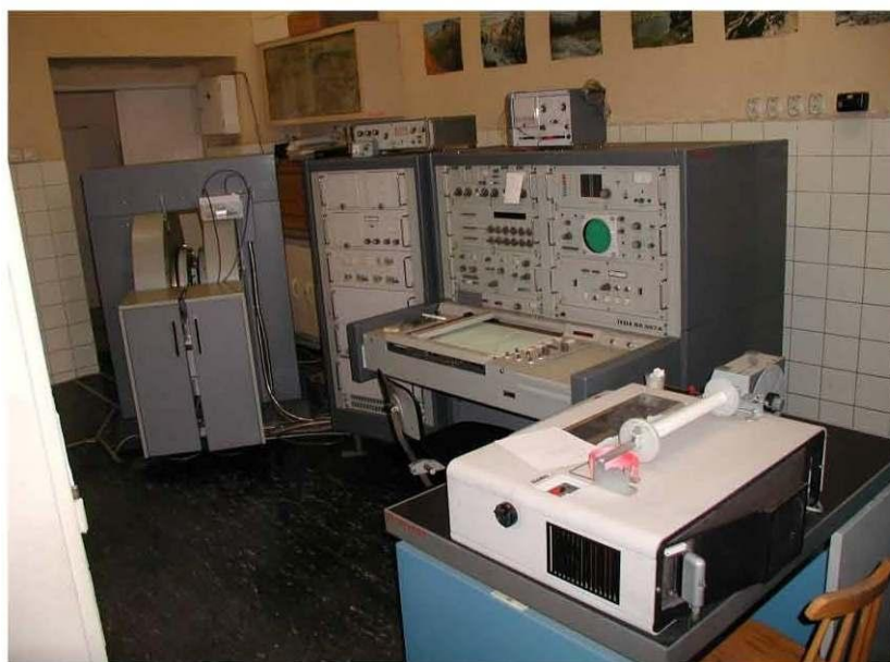
Obr. 5. 100 MHz spektrometr Tesla BS 567A (fotografii poskytnul doc. Ján Imrich, CSC, Košice), bez počítače
