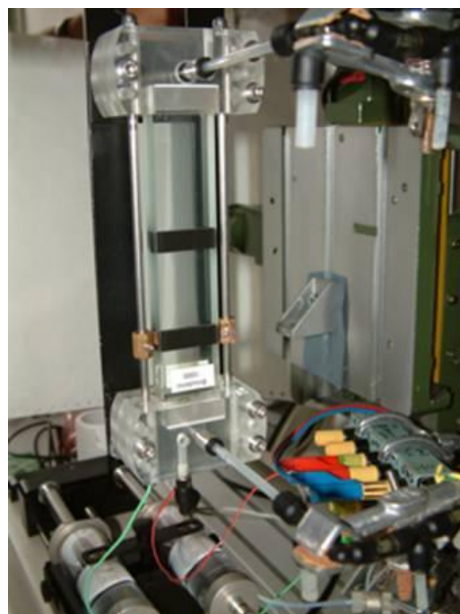
Obr. 9. Štěrbinový mikroreaktor pro elektro-chemickou alkoxylation 4-methylanisolu.
