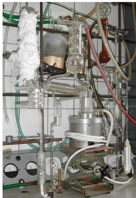
Obr. 3. Generický Dvořákův–Boublíkův recirkulační rovnovážný přístroj (schéma a reál).
