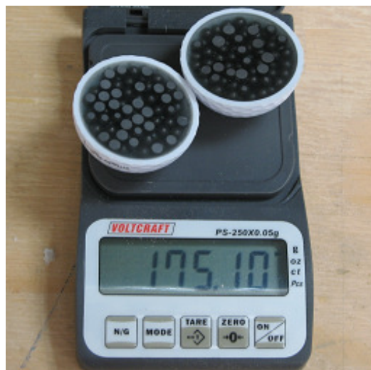
Obr. 10 Konečný model těžšího golfového míčku s olověnými broky a zalité epoxidovou pryskyřicí
