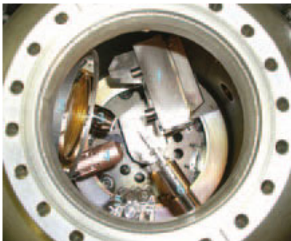
3/ Pohled do komory fotoelektronového spektrometru ADES 400: 1 - analyzátor energie elektronů; 2 - část optiky zařízení pro studium difrakce pomalých elektronů (LEED); 3 - zdroj iontů; 4 - zdroj rentgenového záření; 5 - zdroj ultrafialového záření používaný ke studiu degradace polymerů; 6 - mechanické zařízení (tzv. „pružná ruka“) sloužící k manipulaci se vzorky.
