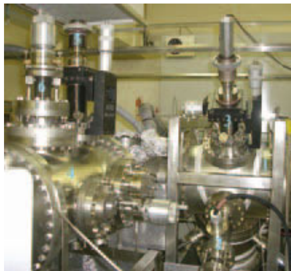
1/ Pohled na centrální část aparatury MBE firmy Kryovak. Vpravo je růstová komora (1) s 15keV elektronovým dělem pro RHEED (2) a rotačním [x, y, z] substrátovým manipulátorem (3). Vlevo je analytická komora (4) vakuově propojená s růstovou a vybavená ohřevem vzorku (5) a analytickým systémem LEED / AES / EELS (6). Stínítko LEED je na odvrácené straně komory.
