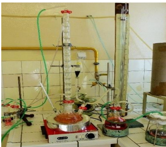
Cirkulační aparatura pro analýzy ^{14}\text{C} ve vzorcích vody kapalných výpustí.
