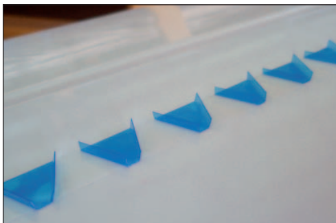
Obr. 7 Virové generátory na horní straně tunelového modelu
