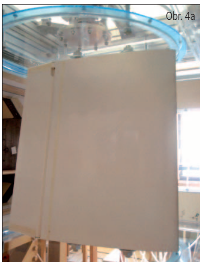
Obr. 4a/b Tunelové modely segmentů konců křídla VSO-10 a HPH304C, rozpětí 485 mm
