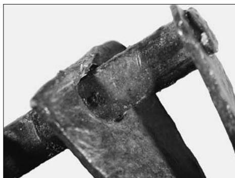
Obr. 6. Detail nasazení třmínku a jazýčku na příčnou osu. Fig. 6. Detail of attached bar and small pointer on the transverse axis.
