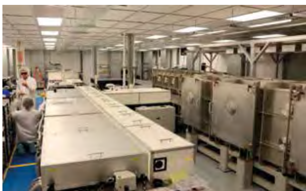
■ Obr. 12 Laserový řetězec L4 ve vývojových prostorech National Energetics. V popředí je subsystém ns OPCPA předzesilovačů a jejich čerpacích laserů, na pravé straně jsou patrné vakuové komory transportních teleskopů ve výstupních zesilovačích.
