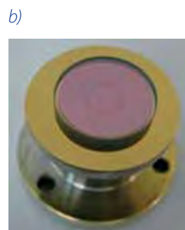
Obr. 7 (a) Vývoj kompaktní laserové hlavičky pro tenkodiskový systém s budícím výkonem < 50 W; (b) prototyp Yb:YAG tenkého disku vyrobeného technikou difuzního bondingu (ADB).
