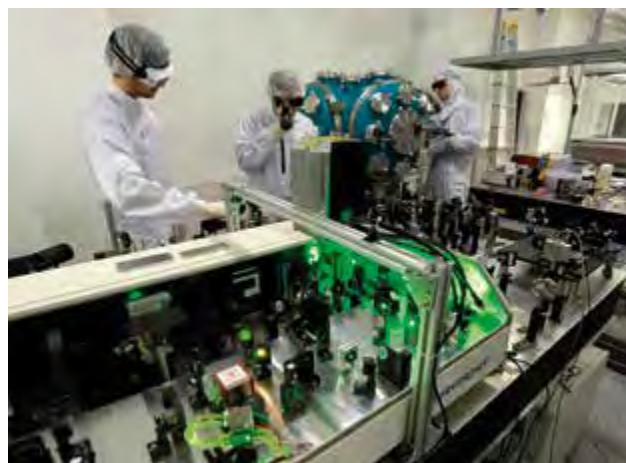
■ Obr. 15 Nastavování 90fs OPA laserového systému čerpaného 125fs Ti:safírovým řetězcem ve vývojové laboratoři FZÚ.
