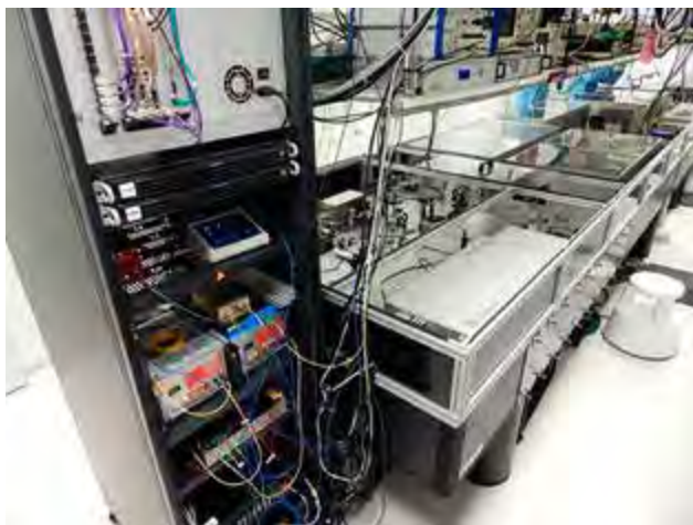
■ Obr. 3 Pohled na první část laserového systému L1 v testovací laboratoři. V popředí část řídicího systému, vláknový předzesilovač, vláknová distribuce injektážních pulsů pro čerpací lasery a femtosekundový oscilátor. Na druhém konci optického stolu se nachází čtvrtý OPCPA zesilovač.
