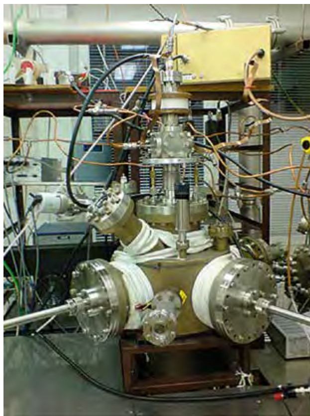
Reaktivní pulzní magnetronový HIPIMS systém pro depozici nanokompozitních antivibračních vrstev \text{CuCN}_x .
