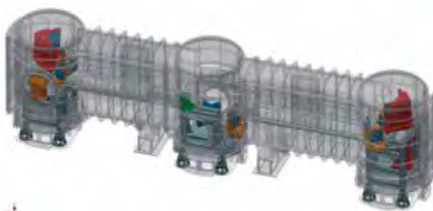
■ Obr. 13 Navržená struktura 10PW kompresoru laserových pulsů systému L4, vypracovaná týmem oddělení 91. Hlavními komponentami kompresoru jsou velkoplošné (850x700 mm) fázované difrakční mřížky, umístěné v krajních věžích kompresoru. Celková délka kompresoru je cca 18 m.
