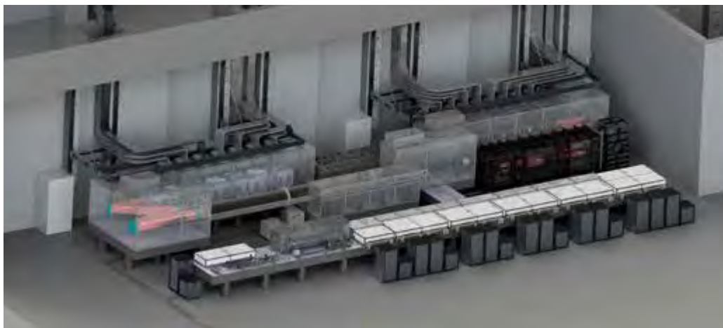
■ Obr. 11 Model kJ laserového systému L4 v hale L4b centra ELI Beamlines.
