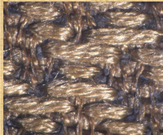
Vzorující hedvábné útkové nitě – 4 neseskané nitě se zákrutem 2z/S, síla 684 \mu
